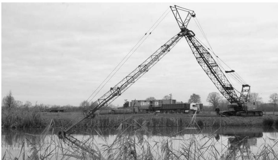
Anlage zur Entschlammung mit Großzentrifugen
