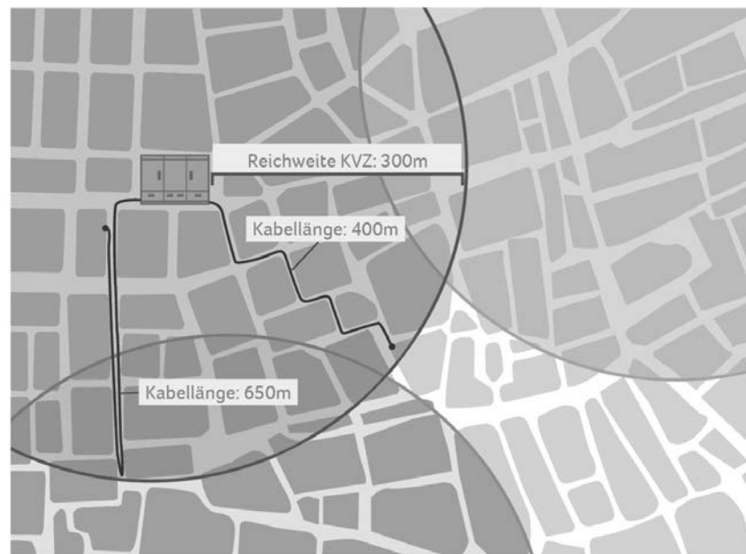
Abbildung 2: KVz-Reichweite: Unterschied Radius - reale Kabellänge
