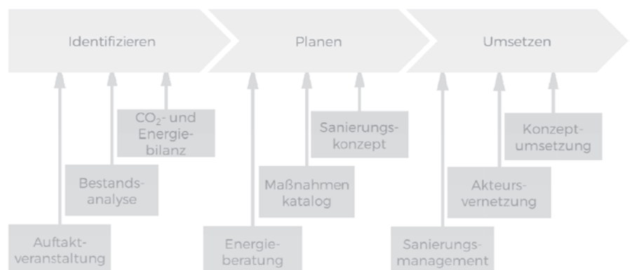
Abb. 1: Untergliederung einer erfolgreichen Wärmnetzplanung mit einem Quartierskonzept
