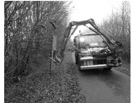
Seitlicher Rückschnitt mit einem Scheren-Aufsatz
