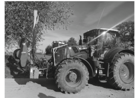
Der seitliche Rückschnitt mit drei rotierenden Sägeblättern.
