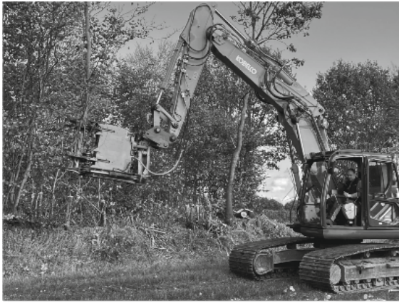
Einsatz einer Knickschere nahe Loft.
