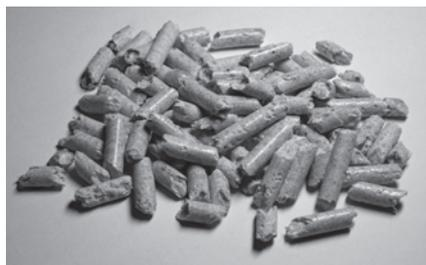
Abb. 1: Pellets – genormter Brennstoff, im Wärmenetz und dezentral einsetzbar<sup>6</sup>
