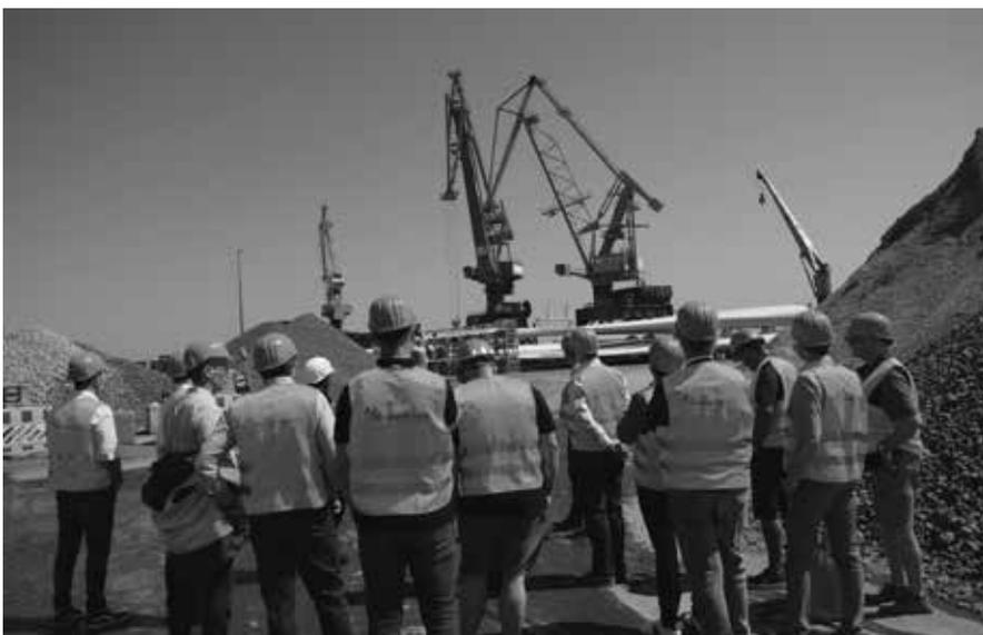
Die Doppellenker-Wippdrehkrane, die im Tandemhub mit einer Hubleistung von 240 Tonnen Schwerlastgüter, aber auch leichtere Stückgüter wie Rotorblätter von Windkraftanlagen bewegen, machten auch mächtig Eindruck. (Foto: Rehder)
