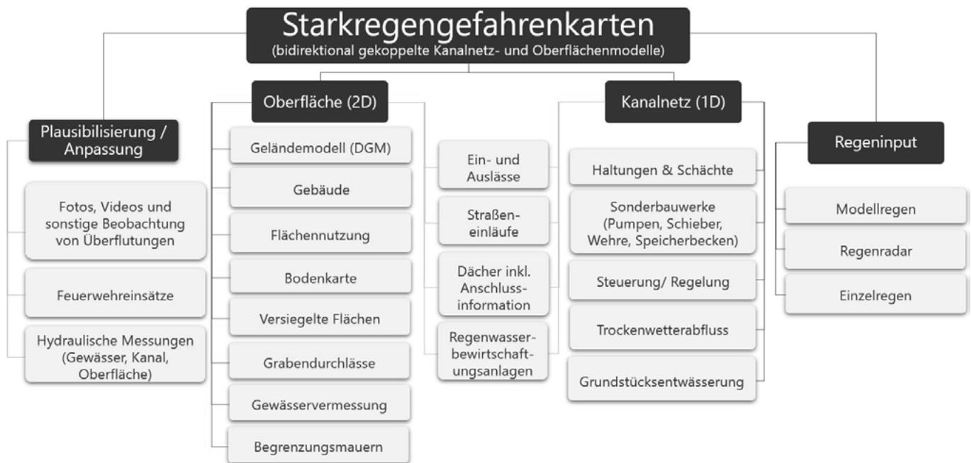
Abbildung 2: Übersicht über Daten für Überflutungsmodelle (Quelle: Hamburg Wasser)
